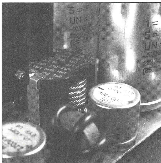
Bild 5. Der Energiespeicher des Schaltnetzgeräts: die Drossel 1.
